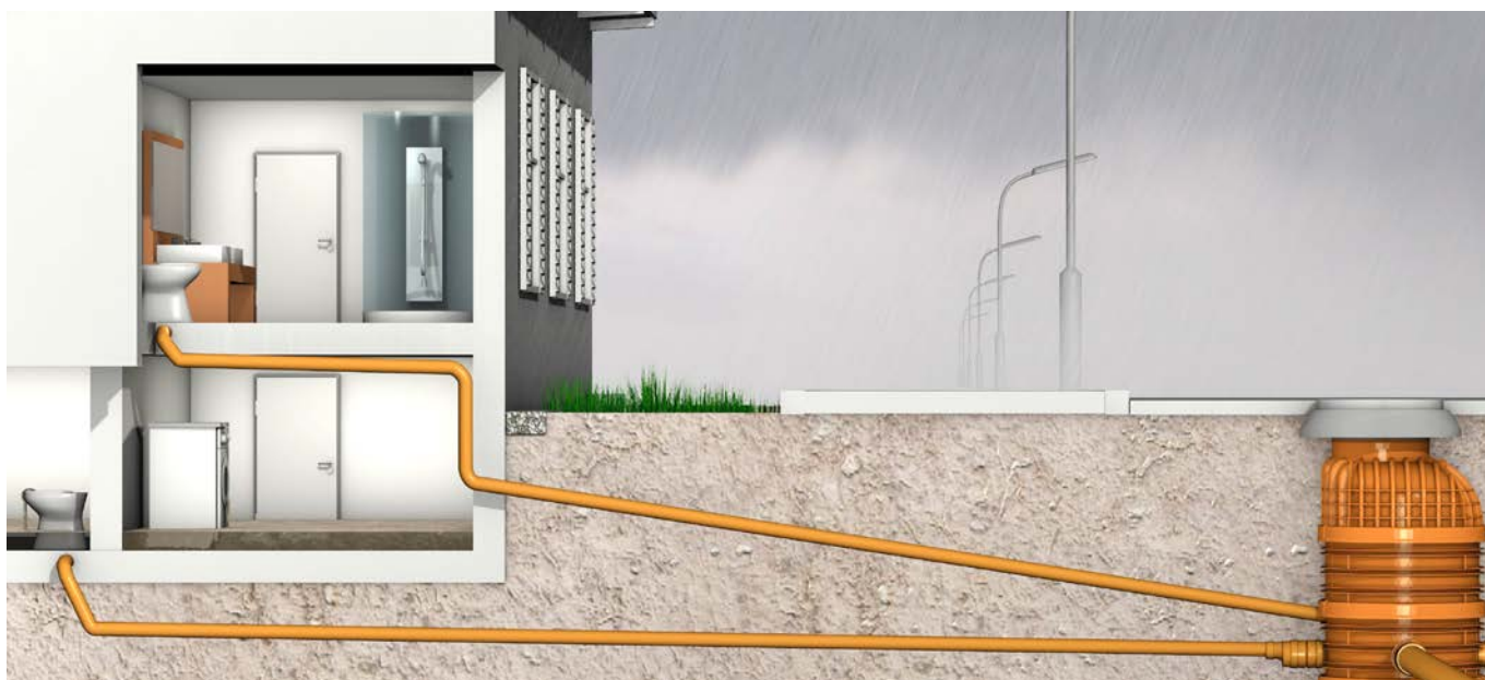
Abwasserrückstau im Keller.
